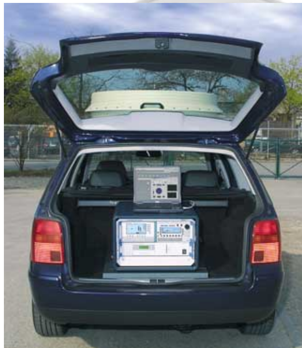
R&S TMS 210 mit Optionen in einem Fahrzeug eingebaut
